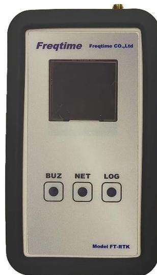
FT-RTK は、Ublox 社 ZED-F9P モジュールを搭載した GPS/GLONASS/Galileo/Bei Dou 2周波マルチ GNSS 受信器で、内部 1000mA Li-po バッテリー or USB type C 給電にて動作します。USB にて NMEA データを 10Hz で出力、RTK 補正データはご使用のスマートフォンを経由して取得、USB メモリーへの記録も出来ますので、座標測定から計測機器への GPS データ供給と 1 台でマルチに使用出来る GNSS 受信器です。
